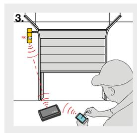
La presencia de un "transmisor" internamente en los receptores OXIT, OX2T y OX4T permite acceder a los códigos radio mediante la interfaz multifunción O-Box.
