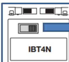
**SENTIDO DE APERTURA:** Vista la instalación desde el interior, mover el selector hacia el lado en el que este colocado el motor.
