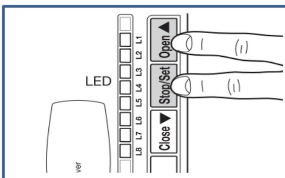
**PROGRAMACION DE ACCESORIOS:** Pulsar OPEN+SET durante 5 segundos para reconocer los accesorios conectados en los bornes de STOP y BLUEBUS
